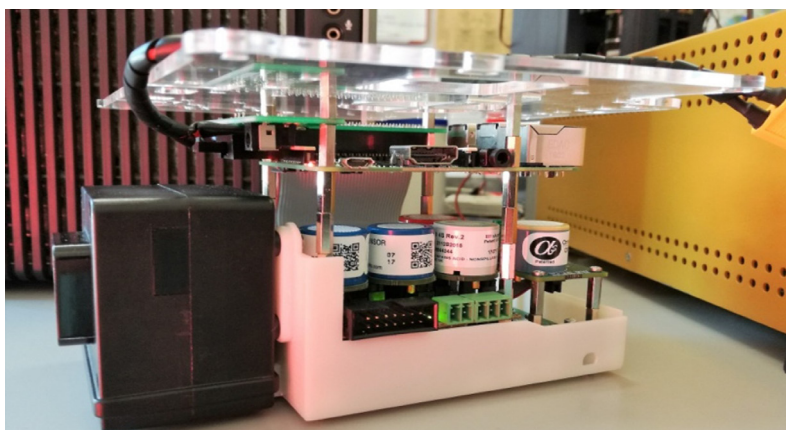
Fig. 5 – Il payload chimico: i cilindri sono i sensori chimici, la scatola nera è per il particolato e, sopra i sensori, la scheda di controllo (Raspberry Pi)
