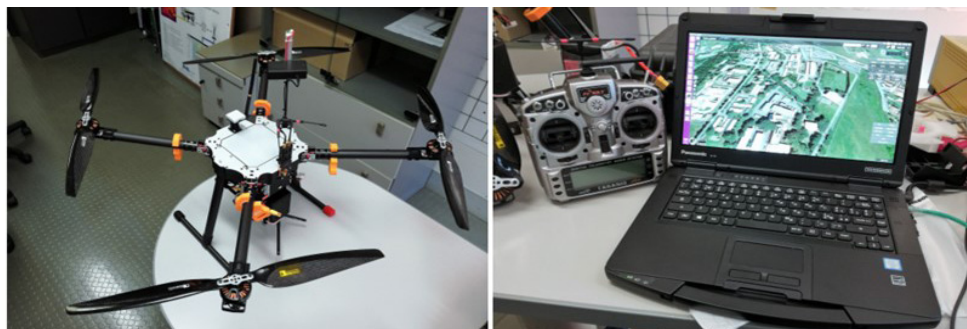
Fig. 4 – Il drone quadri elica (sx) e la sua stazione di terra (dx)
